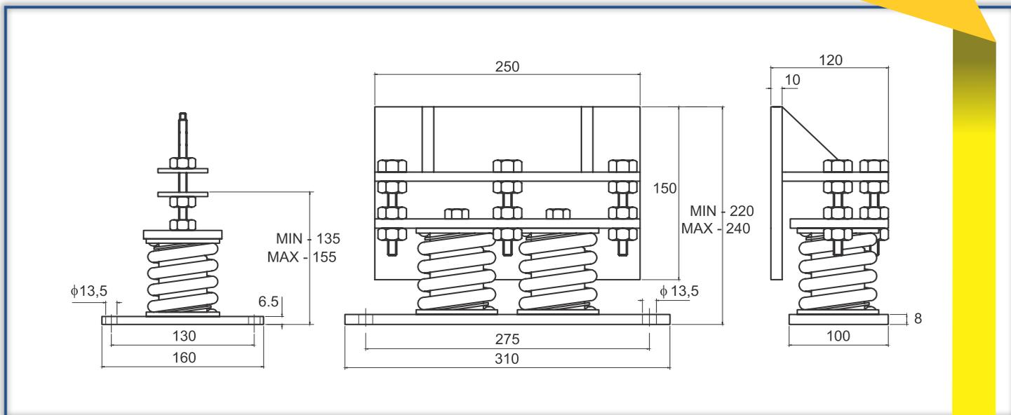
Os Niveladores **VIBRANIHIL** se apresentam como uma idéia que visa facilitar a instalação de máquinas equipadas com amortecedores, permitindo regulagem milimétrica.
