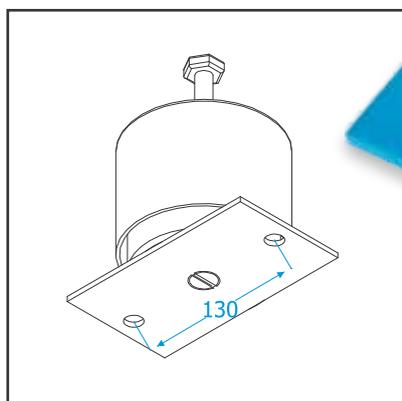
Dimensões para AME 5Hz. Para amortecedores de 2Hz e 3Hz, enviaremos desenho. Altura com carga e outras dimensões ver Fichas Técnicas dos respectivos amortecedores.
