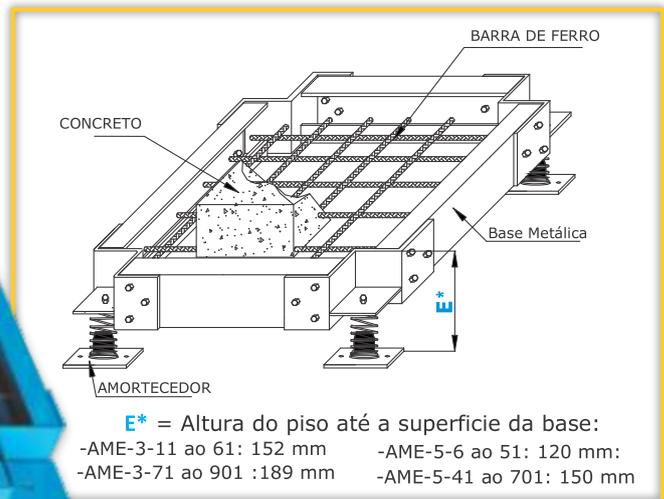
Fornecida montada, basta adicionar o concreto (por conta do cliente).
